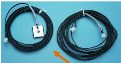
磁石付きセンサ（標準品）＜左＞と磁石を取り外したセンサ＜右＞
