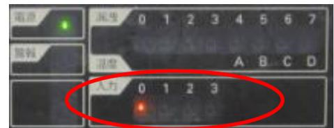
デジタル入力回路に正しく配線がされている場合は、回路が開いているときには検出部は 5V を検知しておりますので、入力は OFF 状態として入力ランプは「消灯」しております。
