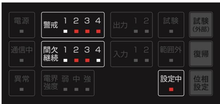
この状態で位相設定ケーブルを電路から外すと、設定中 LED は赤点灯から赤点滅へ変わり、CH4 の警戒 LED も赤点灯から赤点滅へ変わります。
