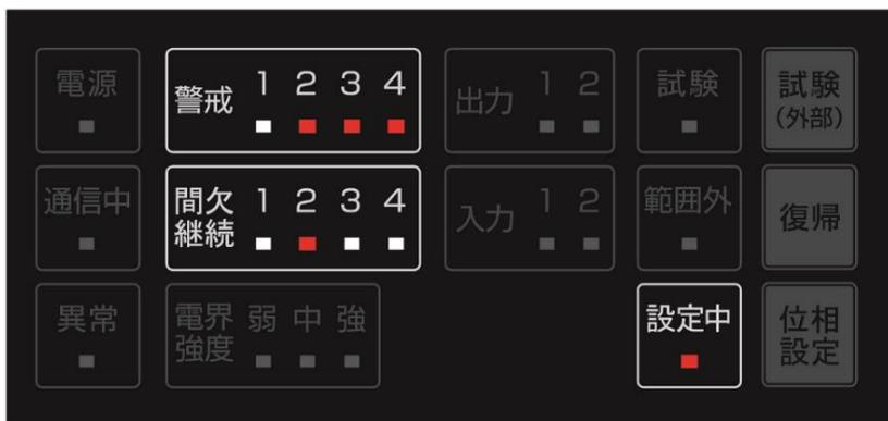
この状態で位相設定ケーブルを電圧から外すと、設定中 LED は赤点灯から赤点滅へ変わり、CH3 の警戒 LED も赤点灯から赤点滅へ変わります。
